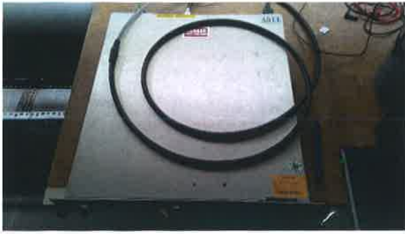
圖四:高壓電產生器
